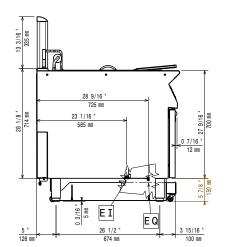
Electrical inlet (power) EQ Equipotential screw
